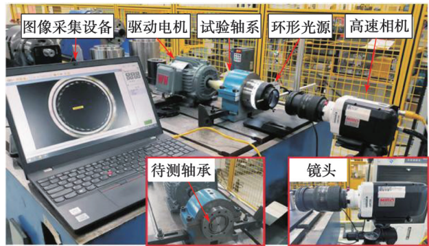
图 11 保持架运动图像采集试验台 Fig. 11 Test rig for capturing cage motion images
